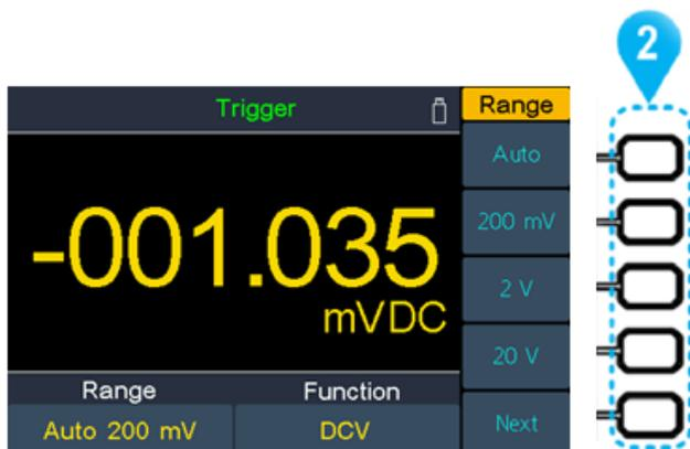
**Automatische Bereichswahl:** Aktivieren Sie die Auto- Funktion über die korrespondierende obere Taste (2) der Softkey-Leiste. Die automatische Bereichswahl wählt den Messbereich abhängig des Eingangswertes, nicht jedoch die Messfunktion.
