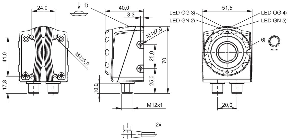
1) Einlernen Referenzbild 2) Betriebsspannung 3) Ausgang 1 aktiv 4) Ausgang 2 aktiv 5) Verbindung mit PC 6) Bildschärfe
