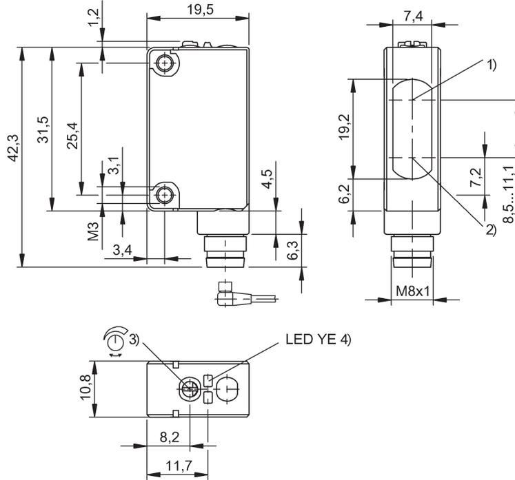
1) Optische Achse Empfänger 2) Optische Achse Sender 3) Sn 4) Ausgangsfunktion
