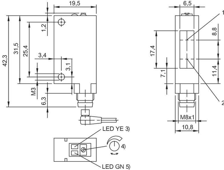
1) Optische Achse Empfänger 2) Optische Achse Sender 3) Ausgangsfunktion 4) Sn 5) Stabilität
