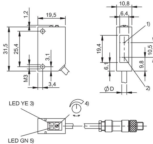
1) Optische Achse Empfänger 2) Optische Achse Sender 3) Ausgangsfunktion 4) Sn 5) Stabilität
