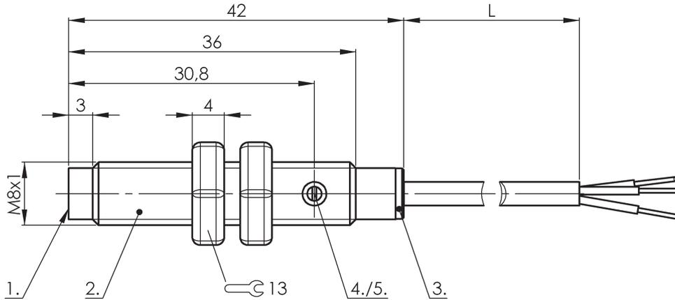
1) aktive Fläche 2) Gehäuse 3) Deckel 4) Poti 5) LED Funktionsanzeige
