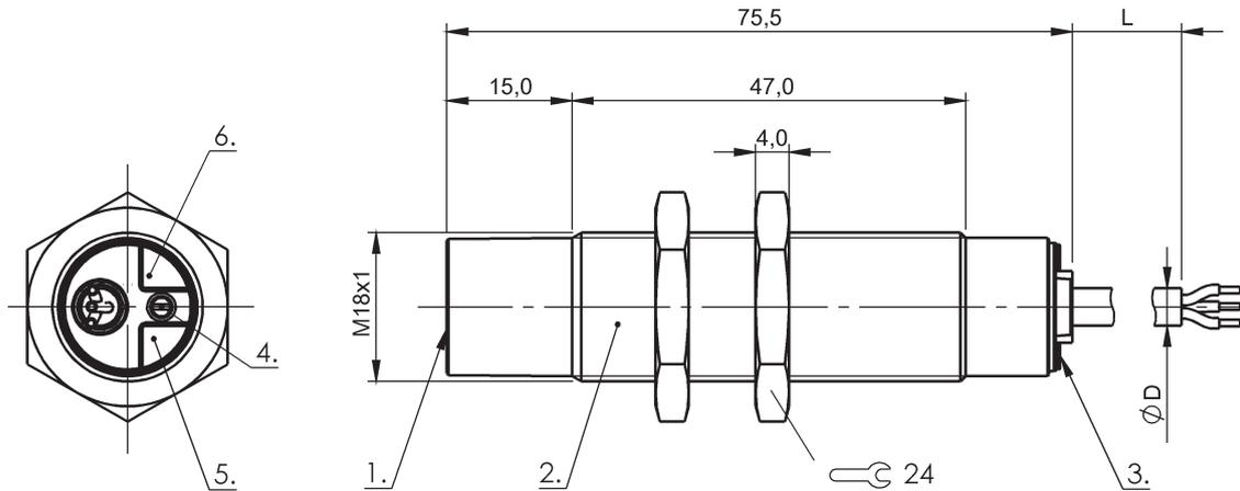
1) aktive Fläche 2) Gehäuse 3) Deckel 4) Poti 5) LED Betriebsspannung 6) LED Funktionsanzeige
