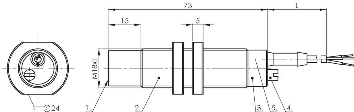
1) aktive Fläche 2) Gehäuse 3) Deckel 4) Poti 5) LED Funktionsanzeige
