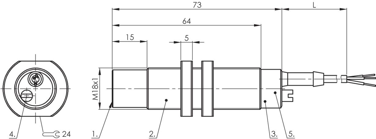
1) aktive Fläche 2) Gehäuse 3) Deckel 4) Poti 5) LED Funktionsanzeige
