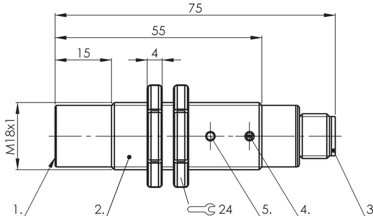
1) aktive Fläche 2) Gehäuse 3) Deckel 4) Poti 5) LED Funktionsanzeige
