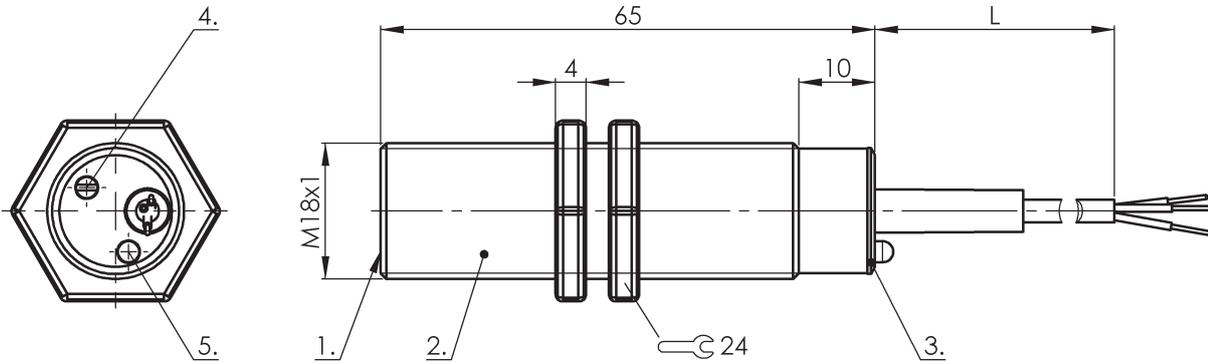
1) aktive Fläche 2) Gehäuse 3) Deckel 4) Poti 5) LED Funktionsanzeige
