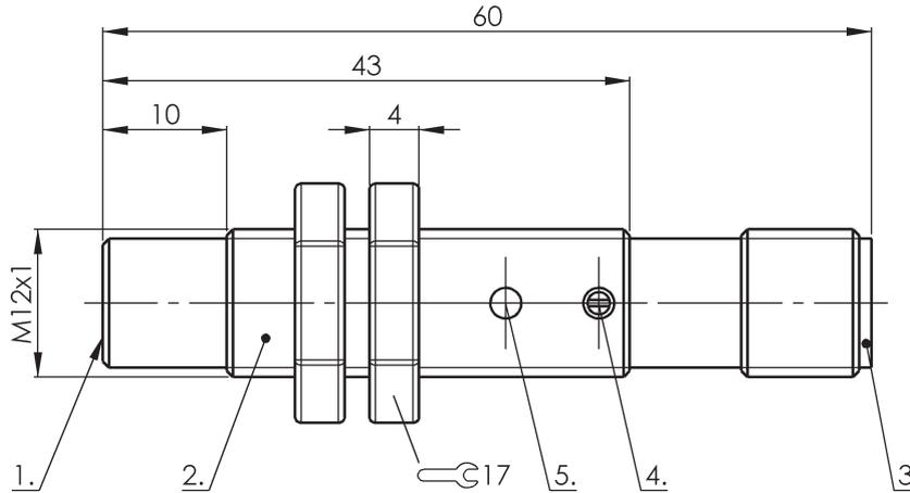
1) aktive Fläche 2) Gehäuse 3) Deckel 4) Poti 5) LED Funktionsanzeige
