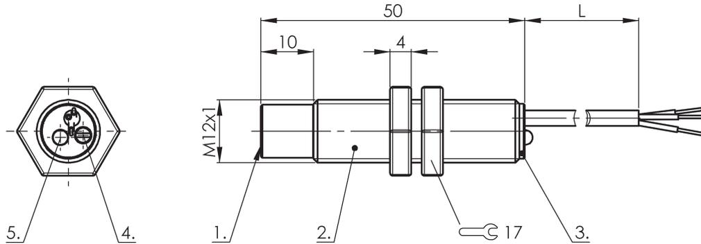
1) aktive Fläche 2) Gehäuse 3) Deckel 4) Poti 5) LED Funktionsanzeige
