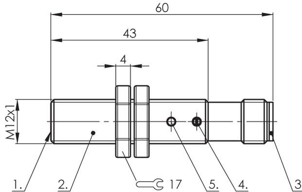
1) aktive Fläche 2) Gehäuse 3) Deckel 4) Poti 5) LED Funktionsanzeige
