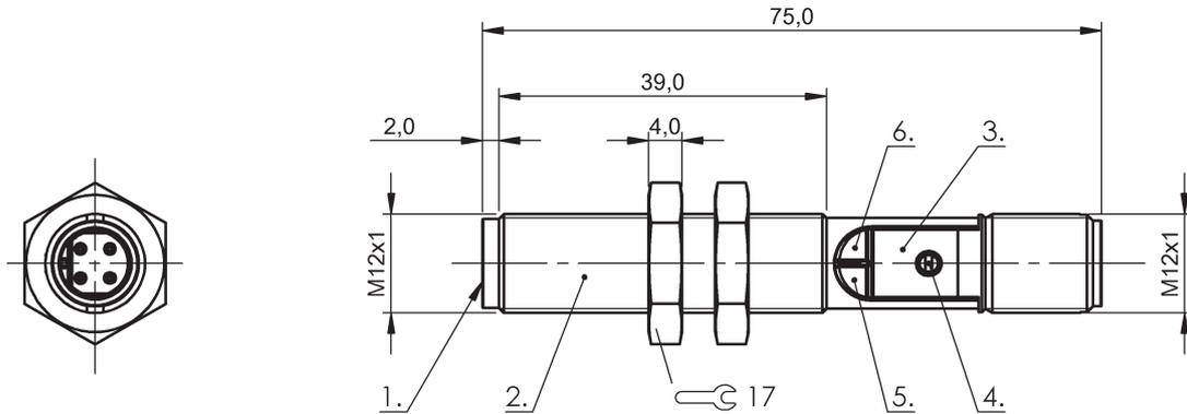
1) aktive Fläche 2) Gehäuse 3) Deckel 4) Poti 5) LED Betriebsspannung 6) LED Funktionsanzeige
